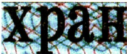
Рис.95. Графические метки в штрихах букв
