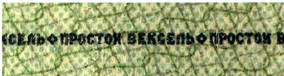
Рис. 91. Микротекст, образующий линейку для записей
