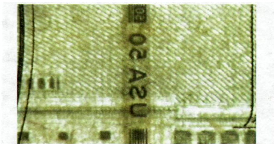
Рис. 72. Маркировка от сетки бумаги на долларовой банкноте
