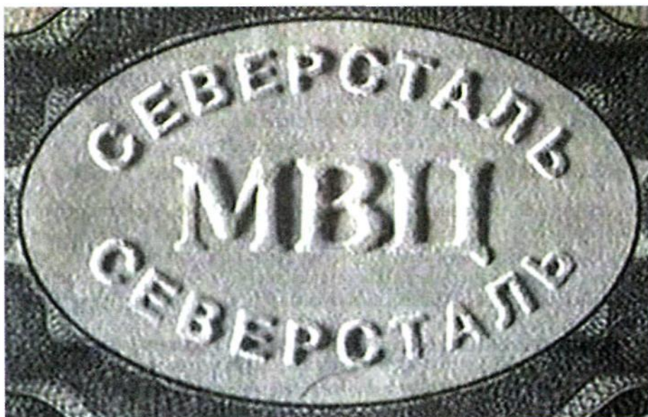
Рис. 101.Фрагмент ценной бумаги, выполненный конгревной печатью
