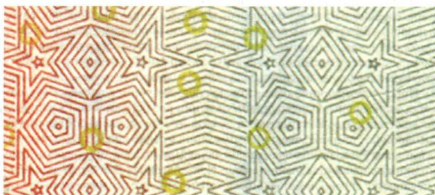
Рис.93. Растр с паутинообразной структурой в графической «ловушке»
