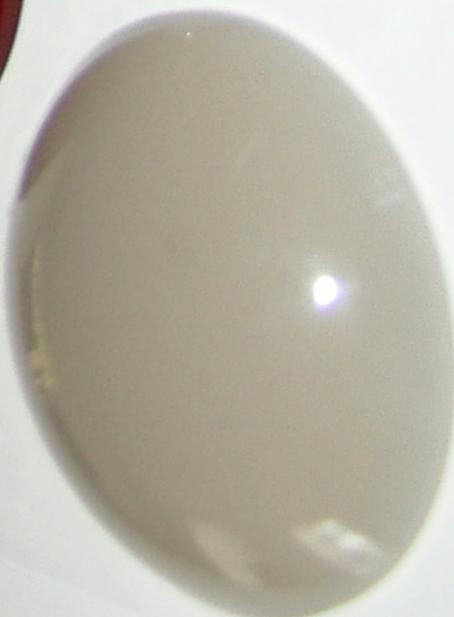
Пропускание шинели (горячее прессование ГИП) [толщина 1.7 мм, без коррекции на отражение].
