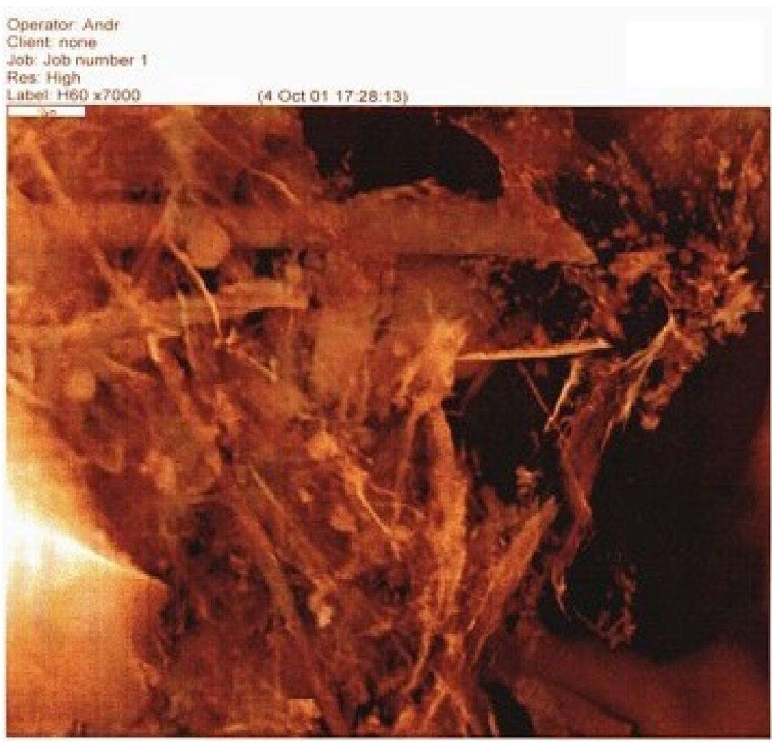
*Углеродные нанотрубки различных диаметров полученные из графенов.*
