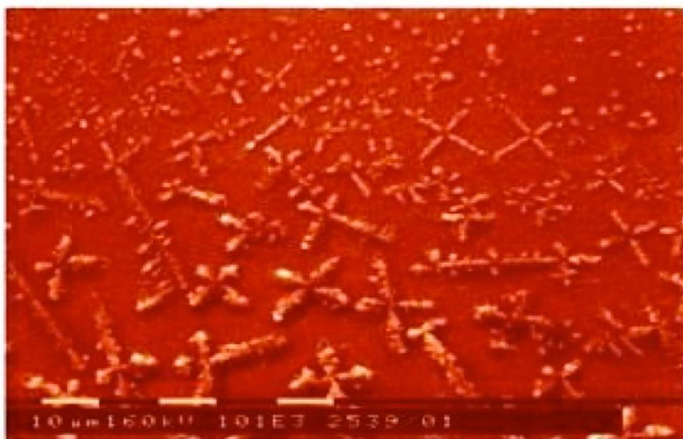
*Фотография выделенных из УСВР углеродных нанофракталов.*
